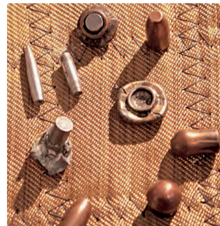
Пули, остановленные тканью бронезилета
